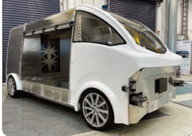
Fahrzeugversuchsträger PLUTO mit prototypischem Aufbau eines Logistikfahrzeugs. —> Foto: Adrian Sonka / TU BS
