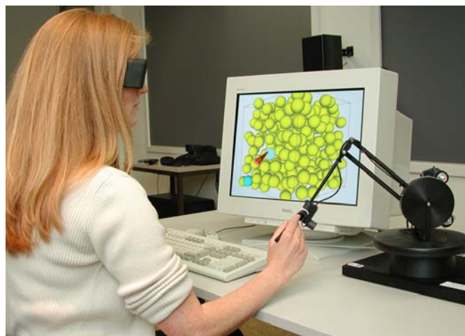
Abb. 6 Force-Feedback- und Trackingsystem PHANTOM, hier zusammen mit 3D-Betrachtung
